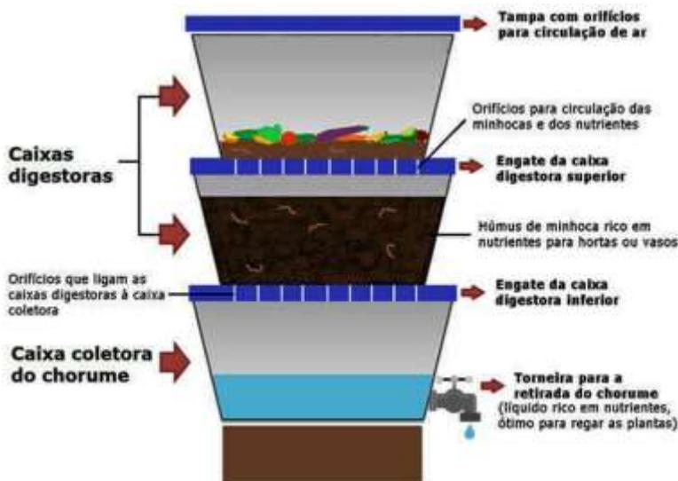
A terceira caixa, também digestora, será utilizada quando a segunda estiver cheia. As minhocas utilizam os furos para migrar para a caixa de cima, quando o processamento de todo o material chega ao fim. Isso significa que o composto já está pronto para ser utilizado.
